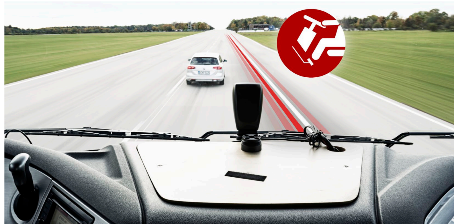
Die Funktion Highway Departure Braking bremst das Fahrzeug auf dem Seitenstreifen, sofern LDW ignoriert wird.
