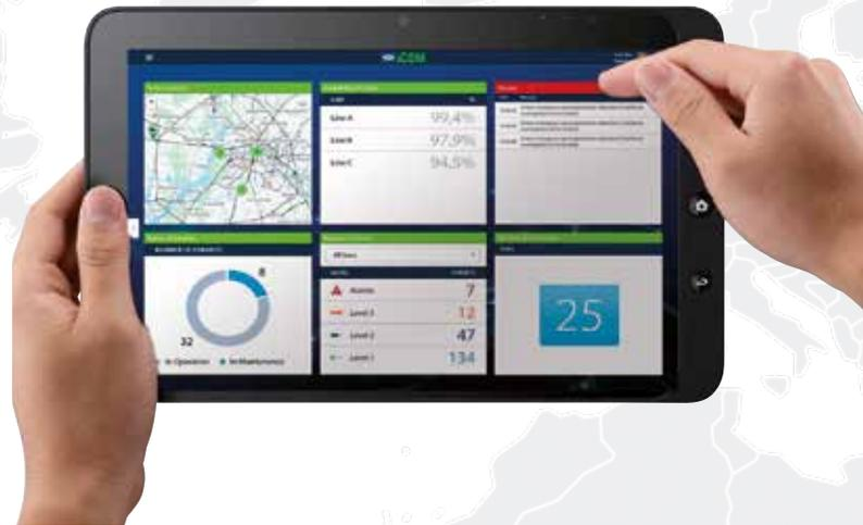
– und können rechtzeitig nötige Schritte einleiten. Das erhöht die Betriebszeiten und vermeidet unnötige Zugausfallzeiten. Betreiber sind mit der iCOM Monitor also in der Lage, von der klassischen Instandhaltung zu einem zustandsbasierten Wartungsansatz überzugehen.
