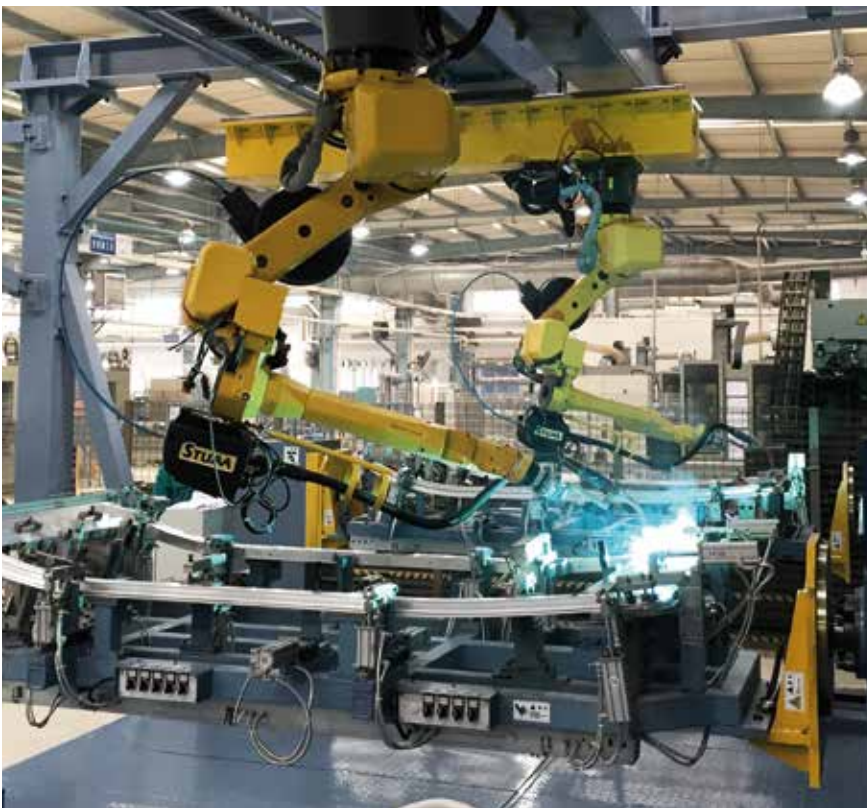
▲ Roboterschweißanlage – die Serienproduktion startete an Türrahmen für den CRH380
