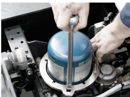
*Spezialwerkzeug für die Wartung der Lufttrocknerkartusche mit Bajonett-Ring in der Anwendung.*
