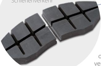
Mit der Übernahme der Schienenverkehrssparte des Reibmaterialherstellers TMD Friction hat Knorr-Bremse auch die sogenannten K-Klötze (Flüsterbremsen) für Güterwagen sowie weitere Produkte der Marke COSID Rail Friction im Angebot.
