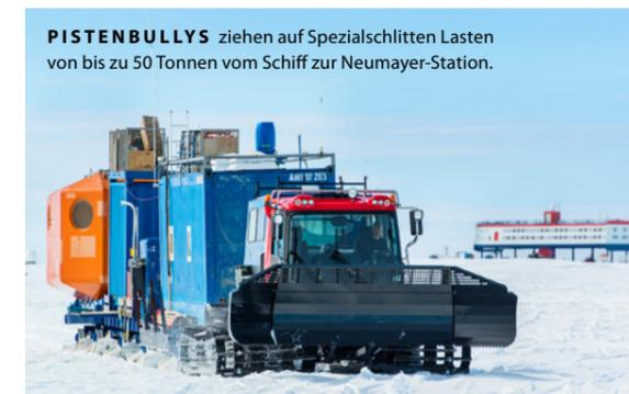
PISTENBULLYS ziehen auf Spezialschlitten Lasten von bis zu 50 Tonnen vom Schiff zur Neumayer-Station.
