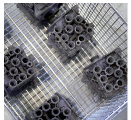
Elemente des Luftaufbereitungssystems EAC nach der Aufarbeitung und kurz vor der Endmontage zum zeitwertgerechten Ersatzteil.
