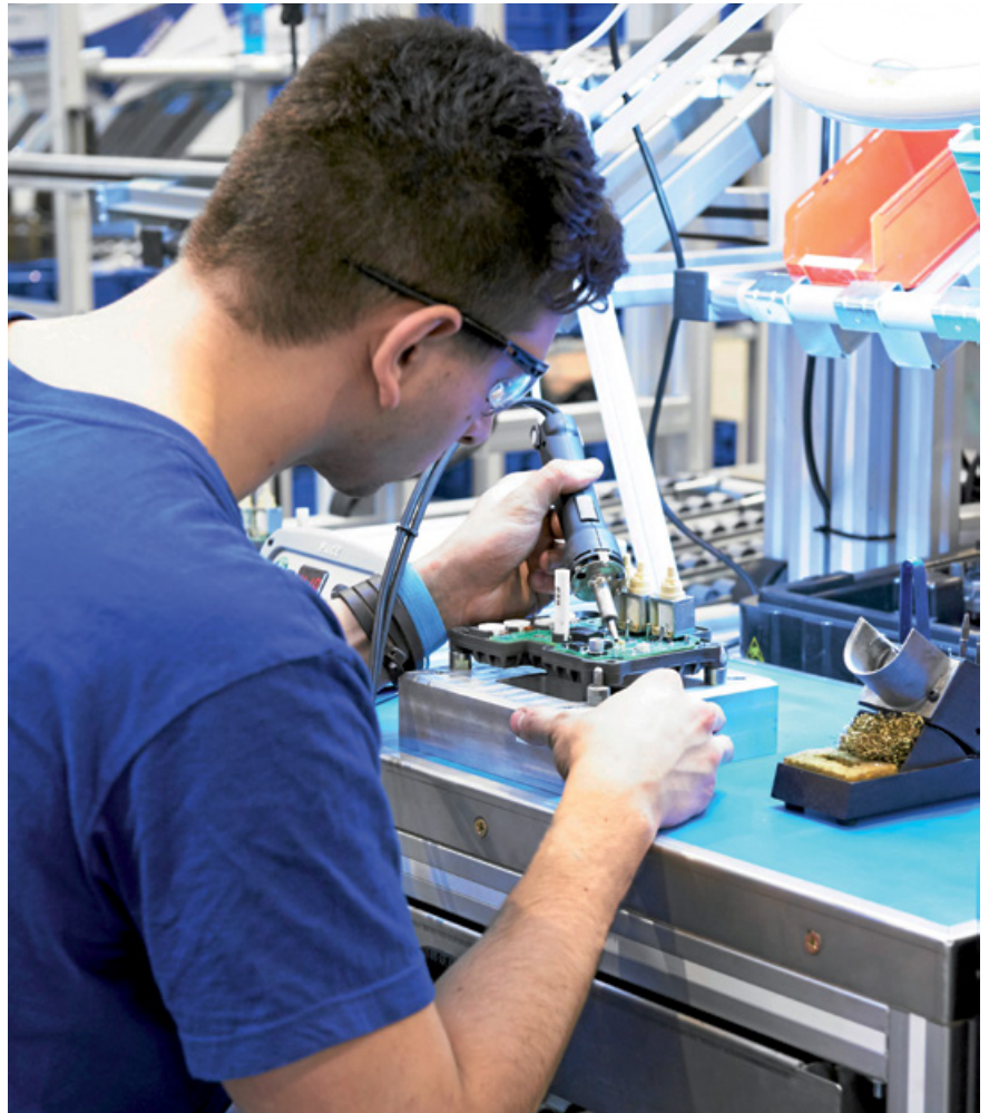
Akribisch werden Platinen wieder auf Vordermann gebracht (r.). Vor dem Remanufacturing lagern die Altteile im Hochregal.
