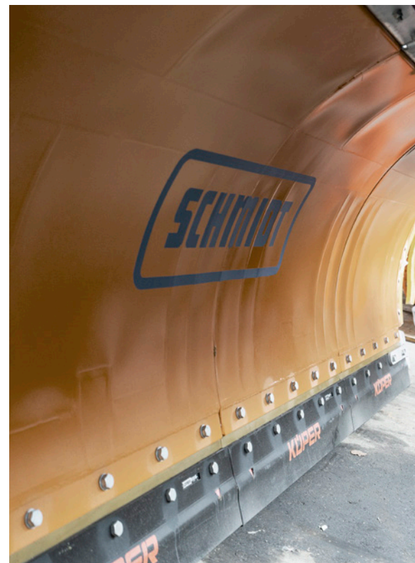
Breite Schultern: Die Pflugbreite der Winterdienst-Lkw beträgt bis zu 4,5 Meter.
