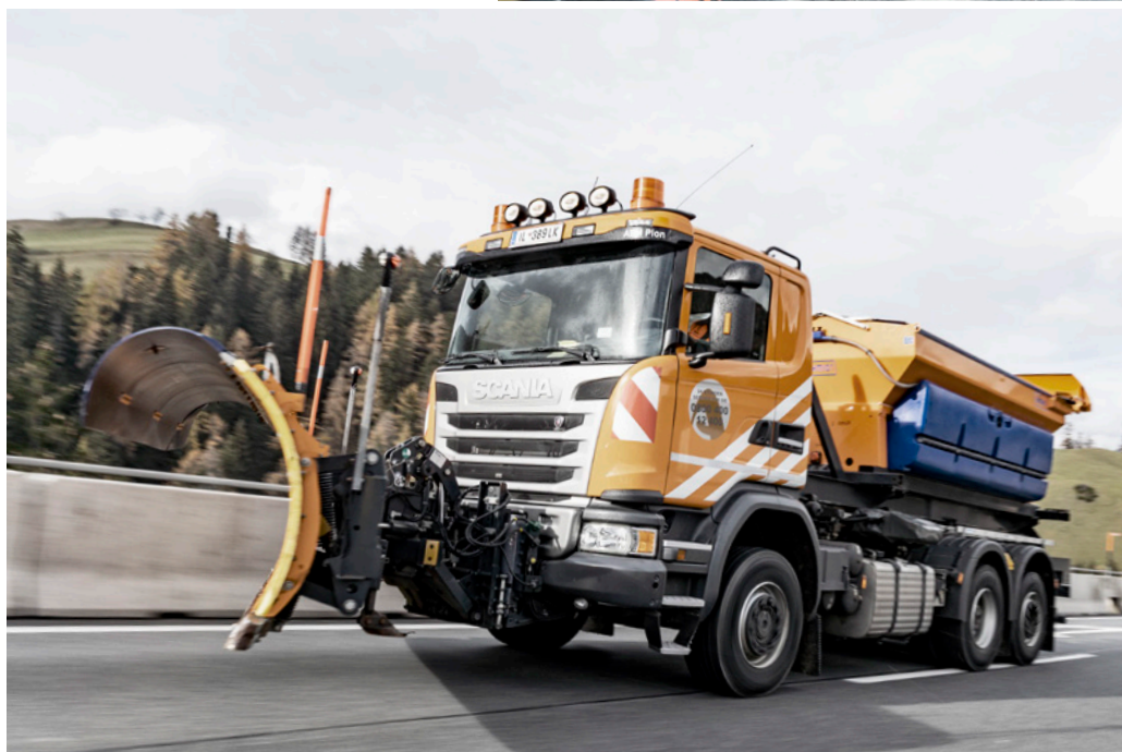
Breite Schultern: Die Pflugbreite der Winterdienst-Lkw beträgt bis zu 4,5 Meter.
