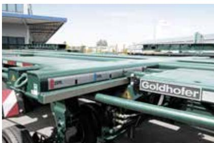
*Für den US-Markt (oben) bietet Goldhofer Schwerlastmodule an, deren Breite während der Fahrt variiert werden kann. Parallelkombinationen (rechts) können künftig mit einem Trailer-EBS-System betrieben werden.*
