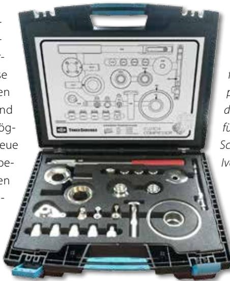
*Alles komplett: Der Werkzeugkoffer für Kupplungskompressoren vereinfacht den Kupplungsservice für die Marken MAN, Scania, Volvo und Iveco.*
