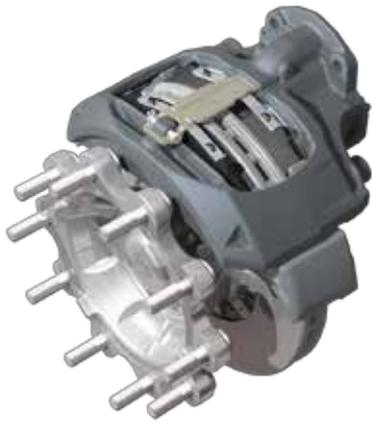
*Tangential verschraubte Bremssättel werden im Nachmarkt mit vormontierten Satteln und Trägern geliefert.*
