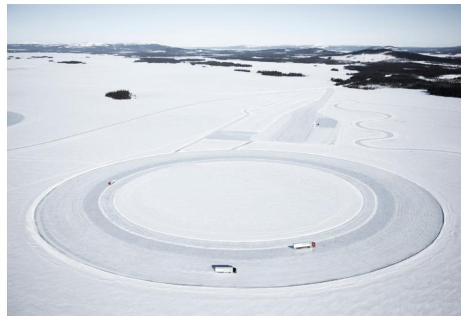
(ATC) durchgespielt, um die schwierigste Berganfahrt überhaupt zu simulieren. Dazu muss der Test-Lkw nicht nur den Gegensatz von Eis und Asphalt in den Griff bekommen, sondern zugleich eine Steigung von 10 bis 15 Prozent überwinden.
