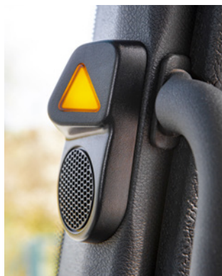
ganz links: Abbiegeassistent im Ruhezustand.
